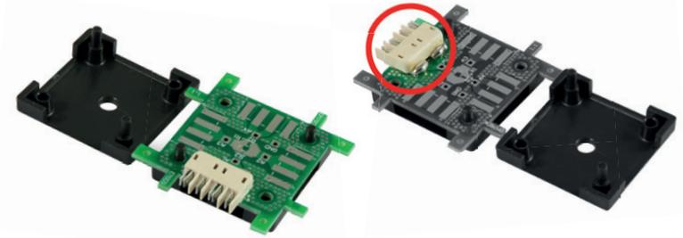
连接brick时, 必须保证插接脚对接正确, 否则会造成损坏甚至短路!
